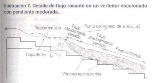
**Ilustración 7. Detalle de flujo rasante en un vertedero escalonado con pendiente moderada.**
